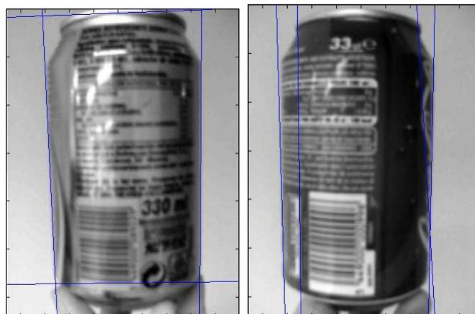
FIG. 12 – Une bonne et une mauvaise détection par la transformée de Hough
