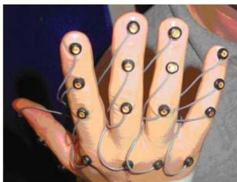
Fig. 2.5 - Positionnement des marqueurs infrarouges sur la main du codeur
