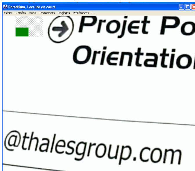
Figure 5-6 : Retour visuel permettant la navigation dans l'image après avoir appliqué un zoom numérique. Ici, on visualise la partie inférieure gauche de l'image capturée. On pourrait déplacer le rectangle vert avec la souris afin de se déplacer dans l'image.
