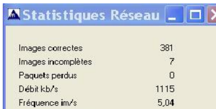
Figure 6-16 : Fenêtre d'affichage des statistiques renseignant le nombre d'images correctement reçues. Ainsi que le débit et la fréquence d'images par seconde.
