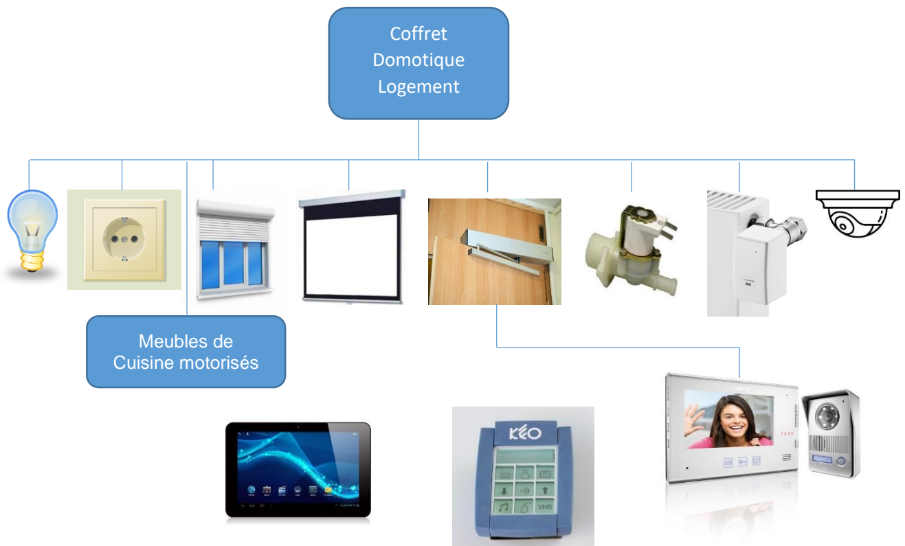
FIGURE 10 : SYNOPTIQUE DE L'INSTALLATION
